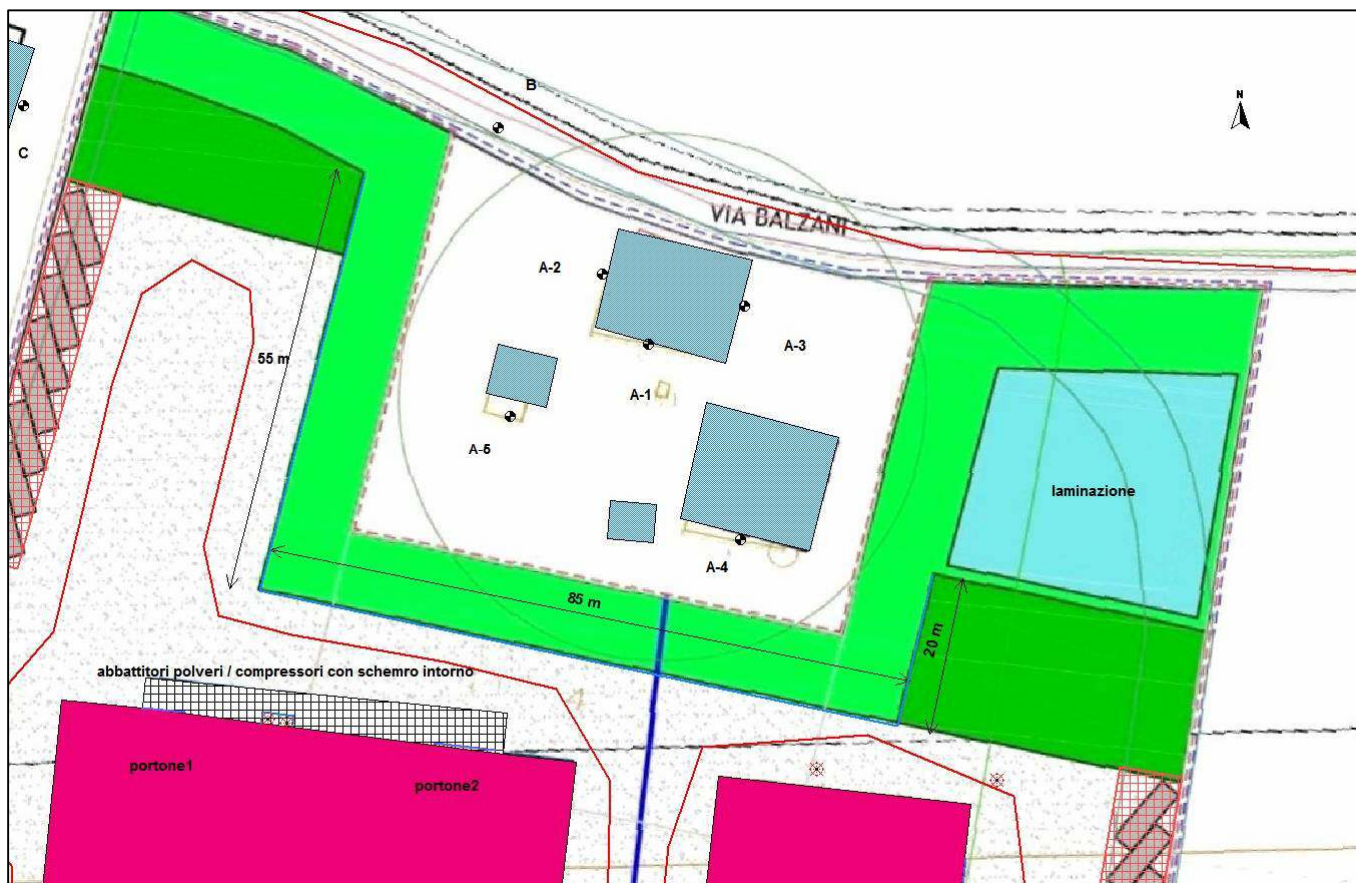
Immagine 11.1 - Mitigazione acustica dei compressori a Nord della SUMATIC ed a servizio di questa + barriera alta 5,5 m dal p.c. lunga in tutto 160 m segmentata come segue
