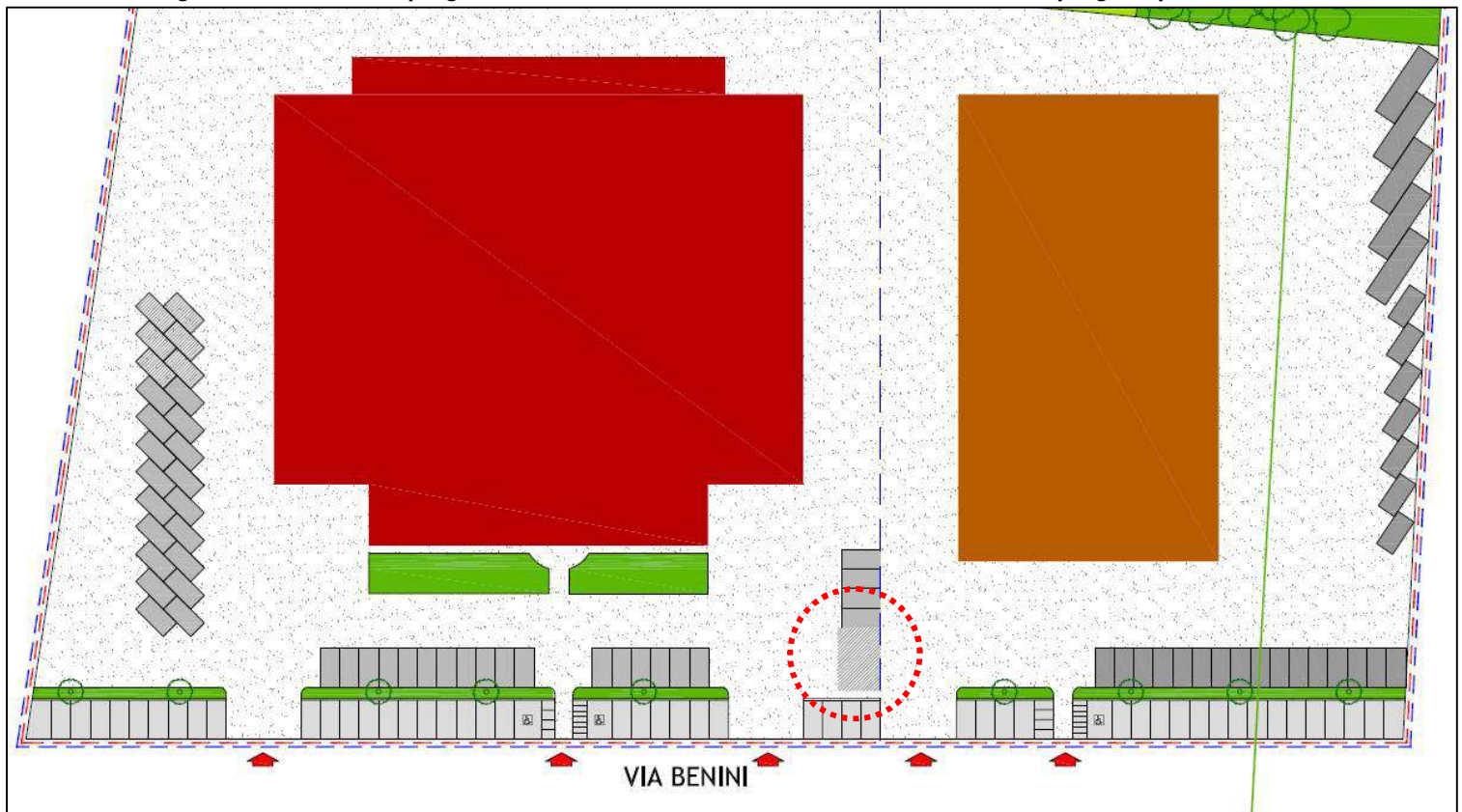
Immagine 16.3 -Stralcio di progetto della rete Enel e della cabina di trasformazione di progetto posta su via Benini
