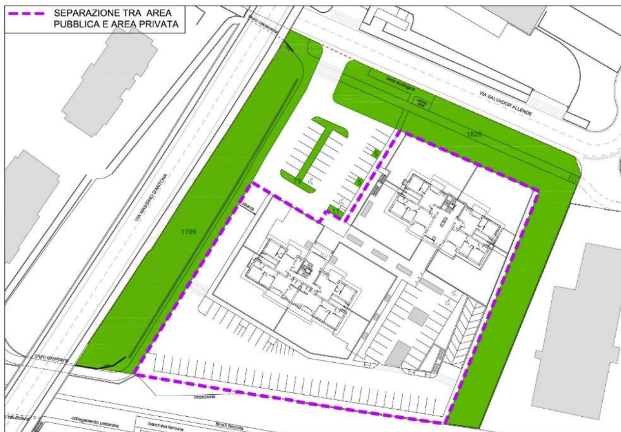
FIGURA 8 – SUPERFICI DI RIFERIMENTO PER IL CALCOLO DEL VOLUME DI LAMINAZIONE AREA PUBBLICA
